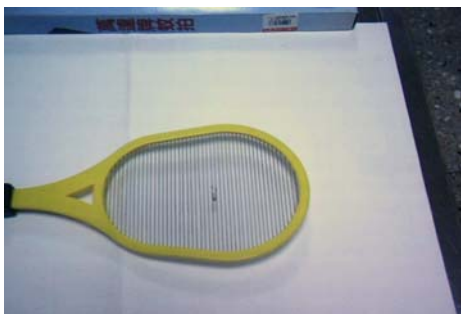
照片三:在电网线上加上两个放电接点
