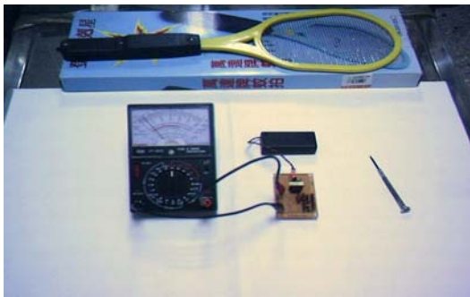
照片二:以多用途电表测量输出电压下限
