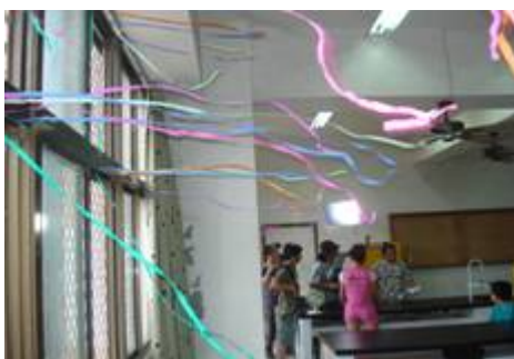
图 16: 打开上层气窗、吊扇反转，气流由外往内飘动
