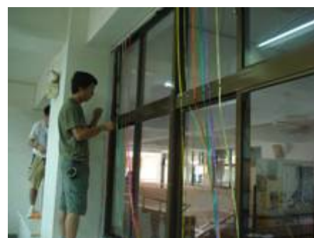
图 17: 即使吊扇反转，上层气窗未开启，气流流动亦不明显
