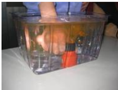
图 3-1、瓶盖钻孔的温热红墨汁，用姆指按住瓶盖，放入冷水底部。
